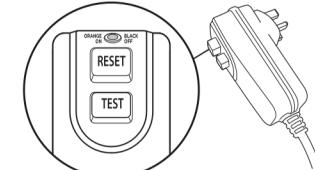
3. Pritisnite gumb TEST na RCD-u. Krug sada treba prikazivati crno. To znači da RCD radi ispravno. Ako pritiskom na tipku TEST krug ne postane crn, kontaktirajte službu za korisnike.
