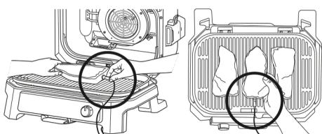
Ispravno postavljanje sonde. Držač sonde je potpuno unutar jedinice.
